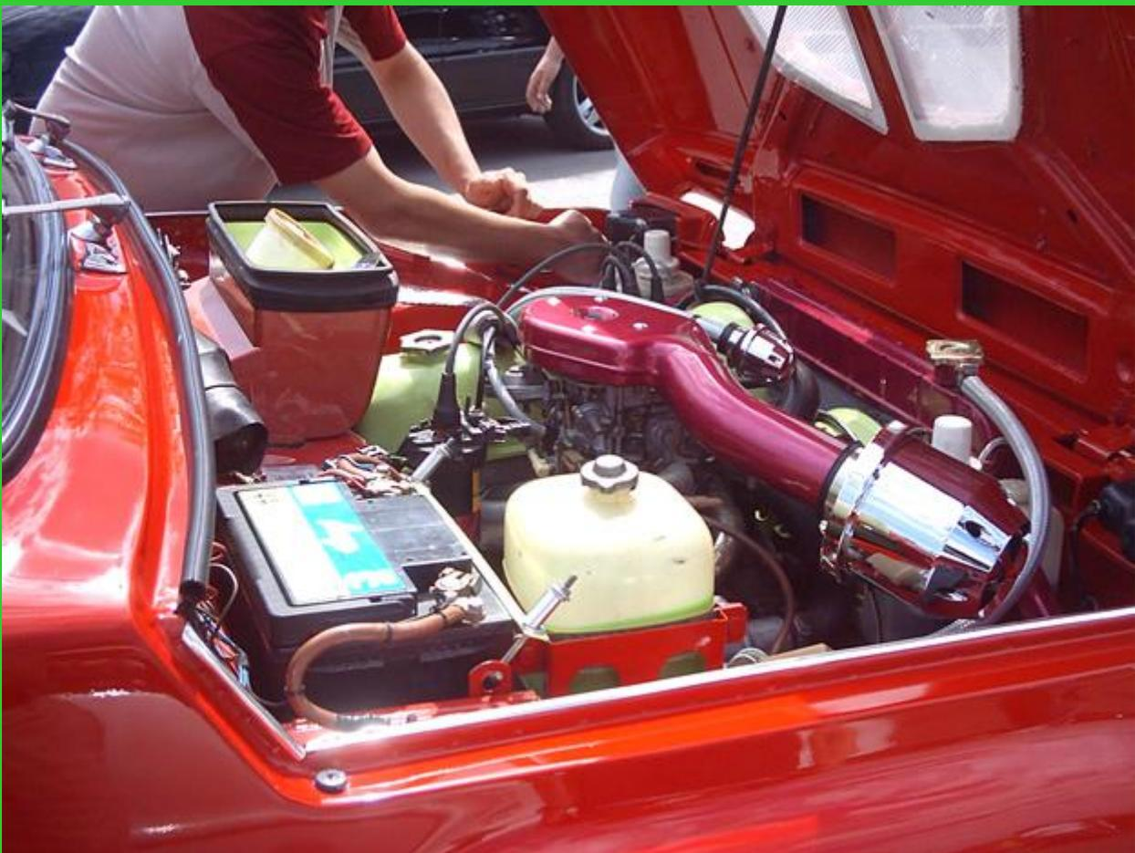
Ejemplo de buena instalación en un niva, suprimiendo la caja del filtro y protegiendo el filtro con una caja metálica del calor del motor. Tan sólo falta un tubo que dirija el aire al filtro y que este sea de algo mayor tamaño.
