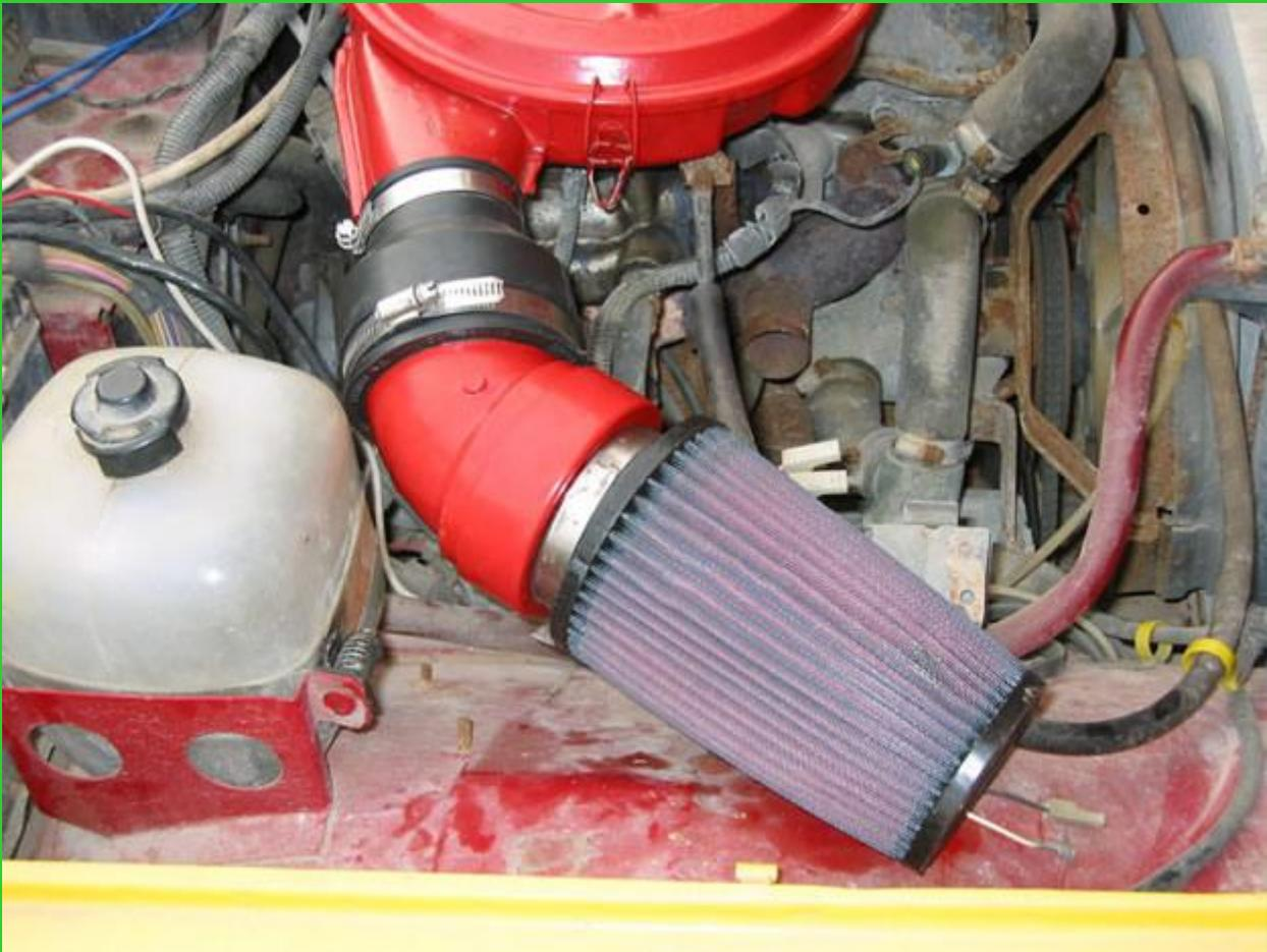
Ejemplo de colocación con codos y manguitos adaptandolo a la caja de filtro original
