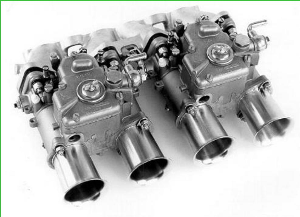
2 Weber 40-DCOE con su correspondiente colector de montaje horizontal
